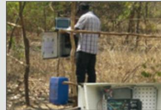
Installation d'une borne d'acquisition de données au Bénin pour AMMA-CATCH, service d'observation à long terme des évolutions climatiques, hydrologiques et écologiques en Afrique de l'Ouest.
