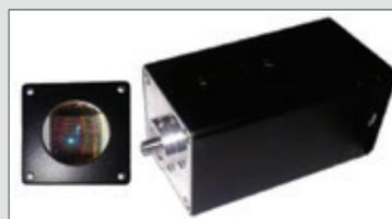
Prototype de spectroimageur ultra miniaturisé rendu possible par l'intégration des fonctions optiques spectro imageantes directement à la surface du détecteur. L'innovation vient de la conception et du développement conjoint du détecteur et des structures miniaturisées comme pour les appareils photo de téléphones portables. Un FUI de spectroimagerie miniaturisée en infrarouge est à l'étude.
