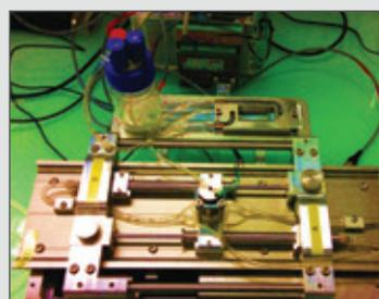
Ce robot original permet de reproduire *in vitro* les contraintes mécaniques subies par les cellules des parois aortiques soumises à un écoulement sanguin et de mesurer leur réponse. Il est actuellement utilisé pour étudier la formation d'anévrismes aortiques, une pathologie qui touche entre 6 et 9 % de la population âgée de plus de 65 ans.
