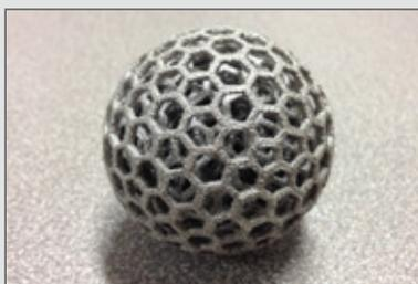
La technologie EBM (Electron Beam Melting) autorise la réalisation de matériaux « sur mesure », architecturés, répondant à des cahiers des charges de plus en plus complexes que des matériaux classiques ne sauraient satisfaire.
