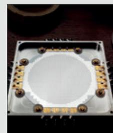
Matrices de NIKA2 : 100 mm de diamètre, 1932 détecteurs observant à une longueur d'onde de 1,2 mm.
