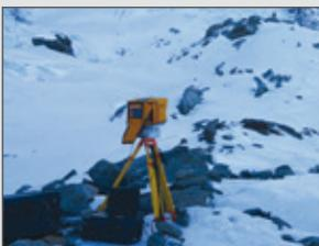
Un lidar terrestre adapté au suivi glaciaire et nival. Précision : 4 mm à 100 m.
